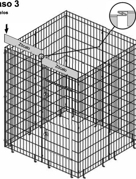
3.- Coloque los Zócalos. Se sujetan a las mallas del frente con tornillos en los taladros correspondientes.
