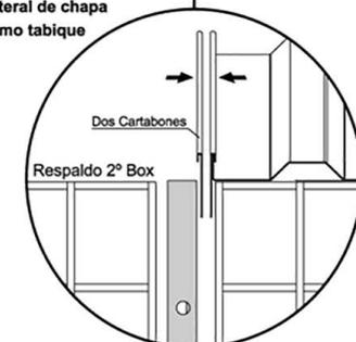
6.- Note que por cada tabique interior, tendrá que colocar dos Cartabones enfrentados. Para colocar el Techo del 2º Box, tendrá que deslizarlo por la guía del techo del primer Box.
