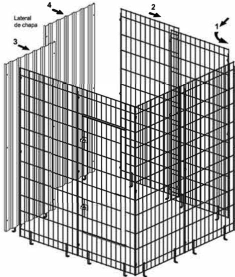
2.2 - Coloque los Laterales de la parte trasera y lateral de la jaula.
