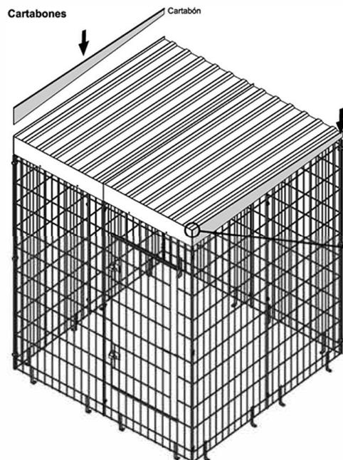
5.- Montar los Cartabones, que van a dos manos. La guía del cartabón engancha con la pestaña del techo. Atornillar a los Laterales.
